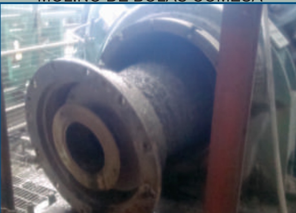
CAMBIO DE TRUNION LINER MOLINO DE BOLAS COMESA
