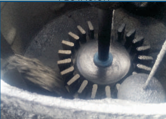
CAMBIO DE TRUNION LINER MOLINO DE BOLAS COMESA
